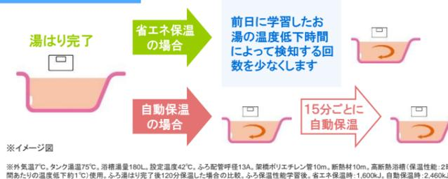
※イメージ図 ※外気温7℃、タンク満温75℃、浴槽満温180L、設定温度42℃、ふろ配管呼径13A、架橋ポリエチレン管10m、断熱材10m、高断熱浴槽(保温性能:2時間あたりの温度低下約1℃)使用。ふろ湯はり完了後120分保温した場合の比較。ふろ保温性能学習後、省エネ保温時:1,600kJ、自動保温時:2,460kJ。
